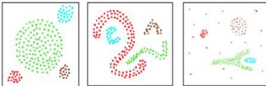
Рис. 2 – Примеры кластеров произвольной формы, распознанных DBSCAN
